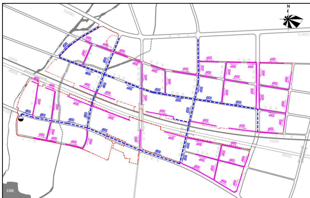
图 3.2-1 污水处理站收水管网图
