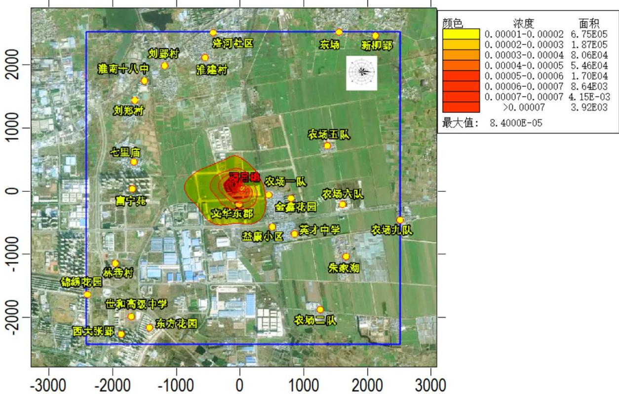
图 5.2.10-6 网格点处 NO<sub>2</sub> 最大年均浓度贡献值等值线图 (单位:  $\mu\text{g}/\text{m}^3$ )
