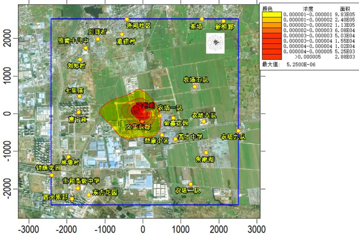
图 5.2.10-3 网格点处 SO<sub>2</sub> 最大年均浓度贡献值等值线图 (单位:  $\mu\text{g}/\text{m}^3$ )
