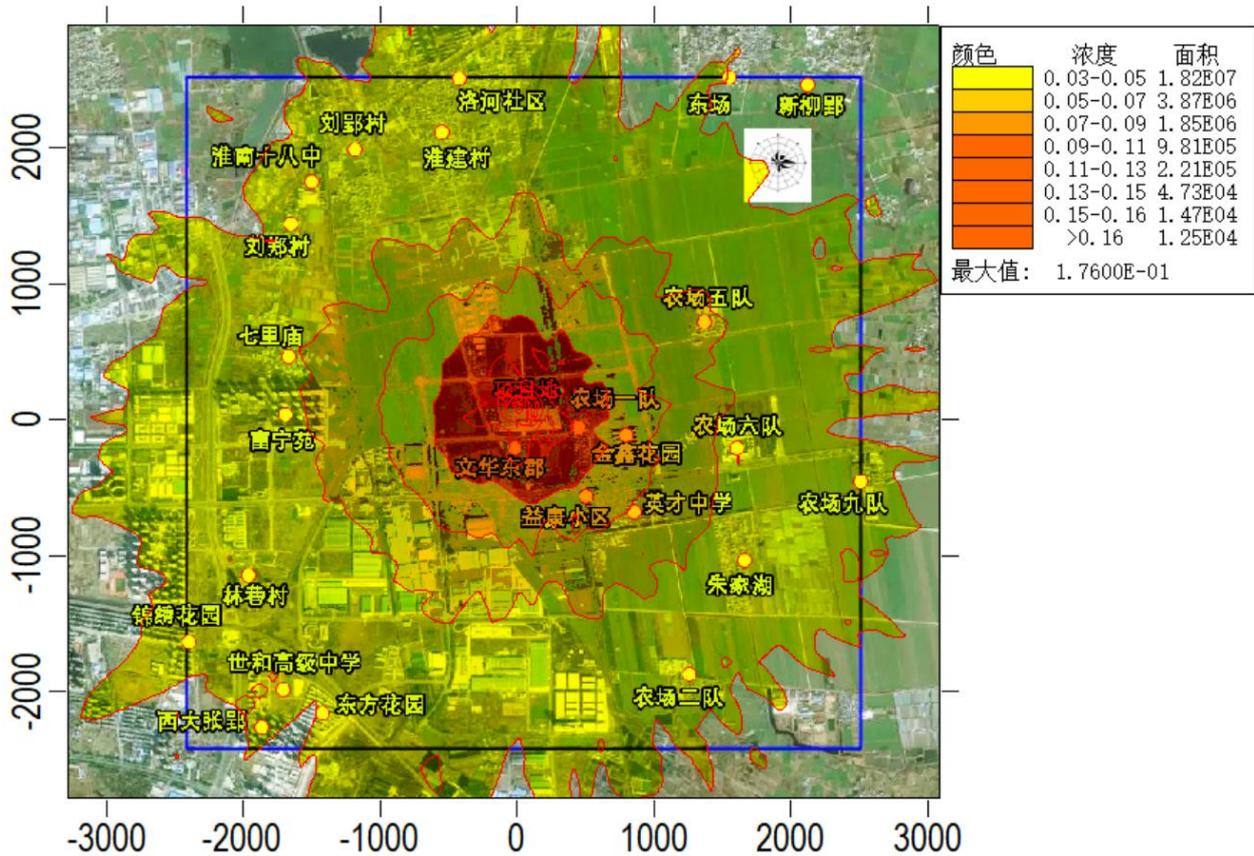
图 5.2.10-33 非正常工况下网格点处 PM<sub>2.5</sub> 小时浓度贡献值等值线图 (单位:  $\mu\text{g}/\text{m}^3$ )
