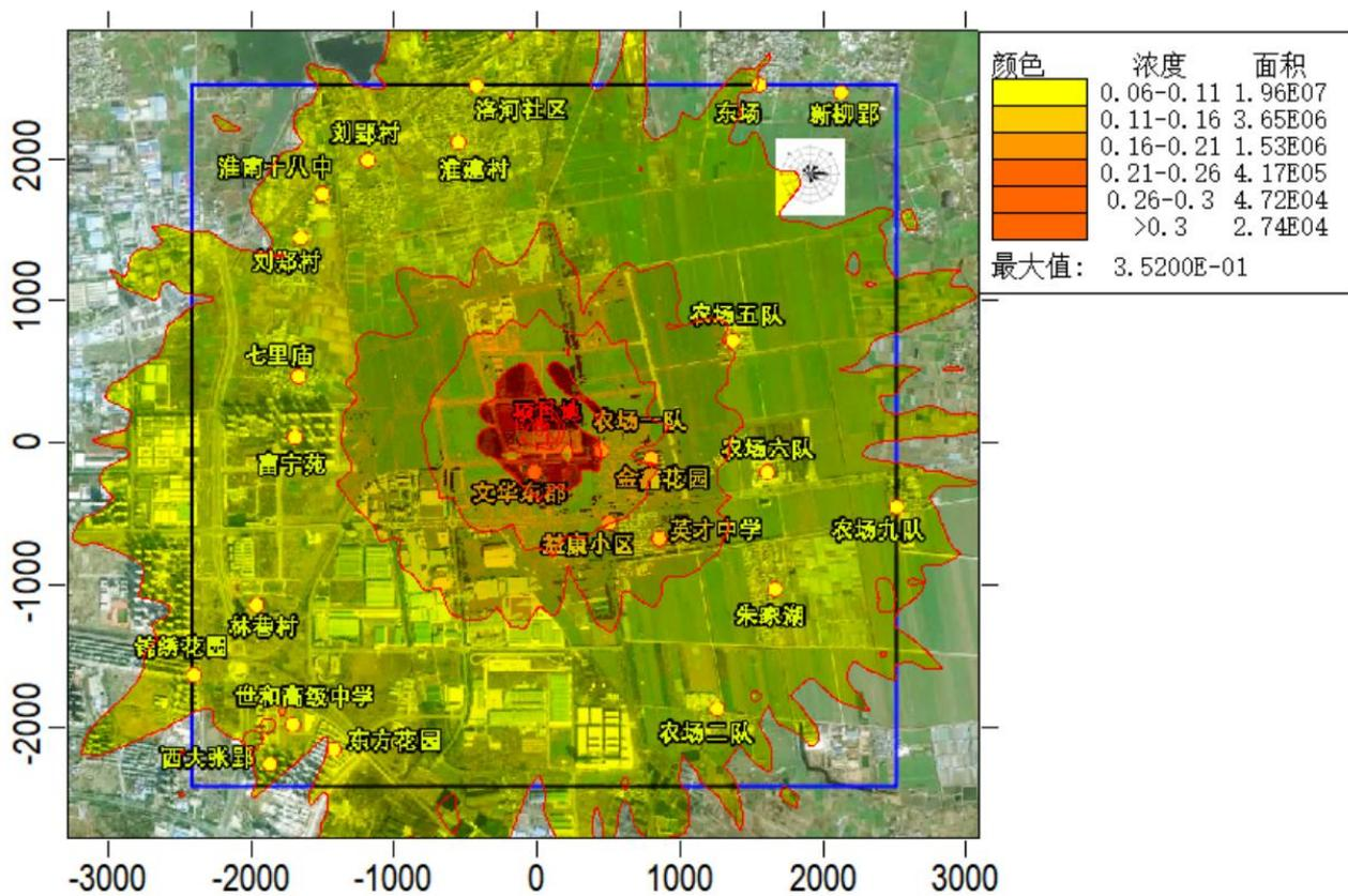
图 5.2.10-32 非正常工况下网格点处 PM<sub>10</sub> 小时浓度贡献值等值线图 (单位:  $\mu\text{g}/\text{m}^3$ )
