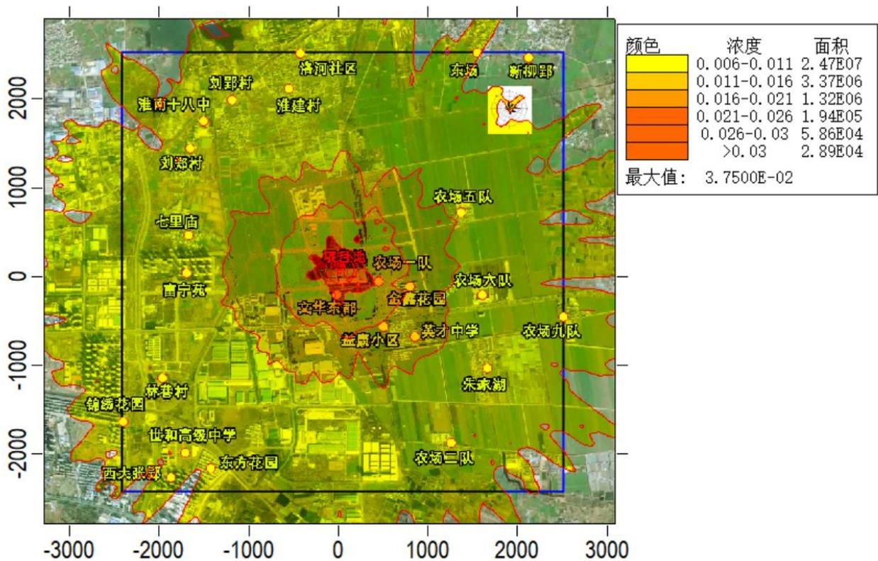
图 5.2.10-36 非正常工况下网格点处锰及其化合物小时浓度贡献值等值线图(单位:  $\mu\text{g}/\text{m}^3$ )
