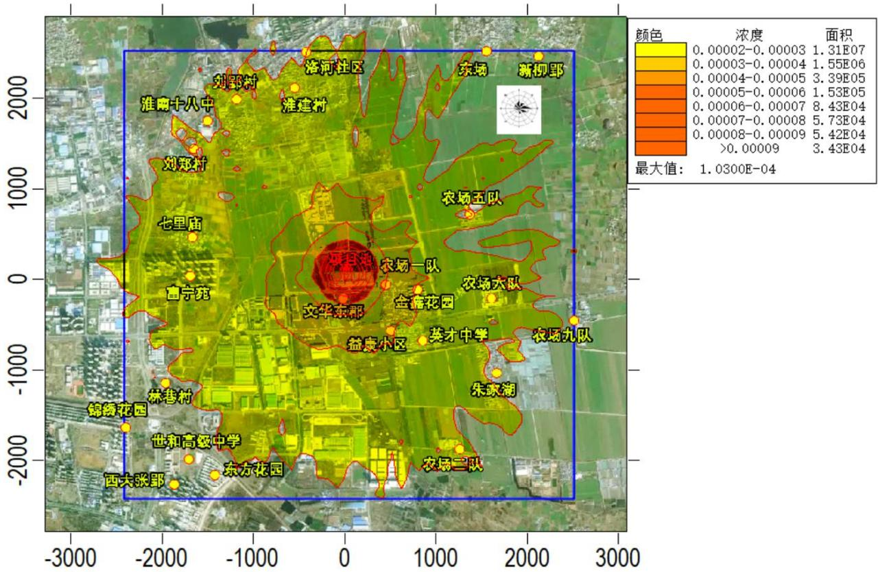
图 5.2.10-30 非正常工况下网格点处 SO<sub>2</sub> 小时浓度贡献值等值线图（单位：μg/m<sup>3</sup>）
