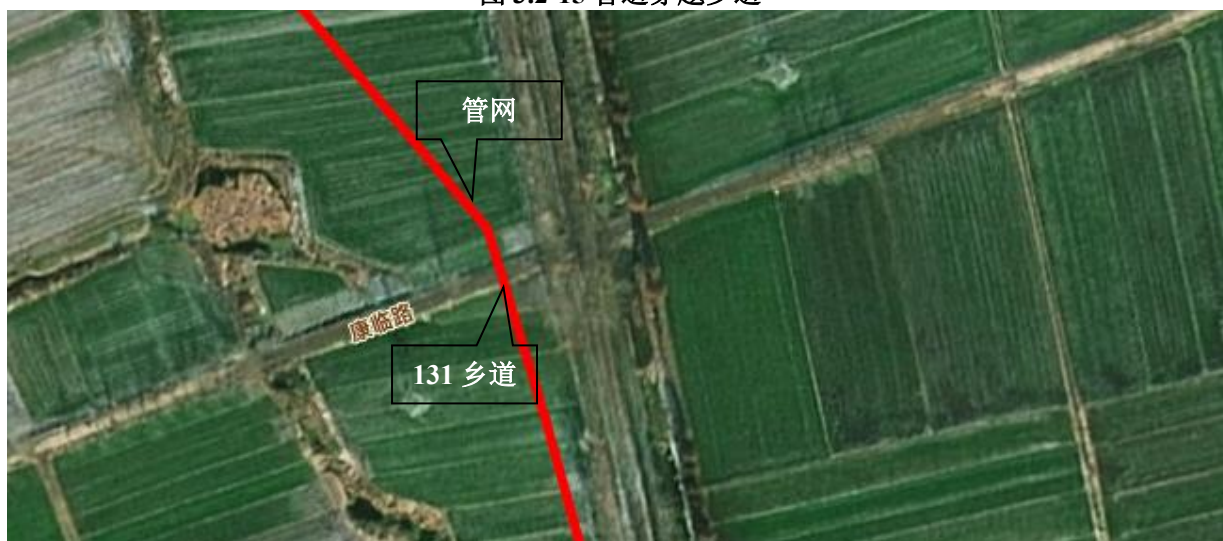
图 3.2-16 管道穿越乡道
