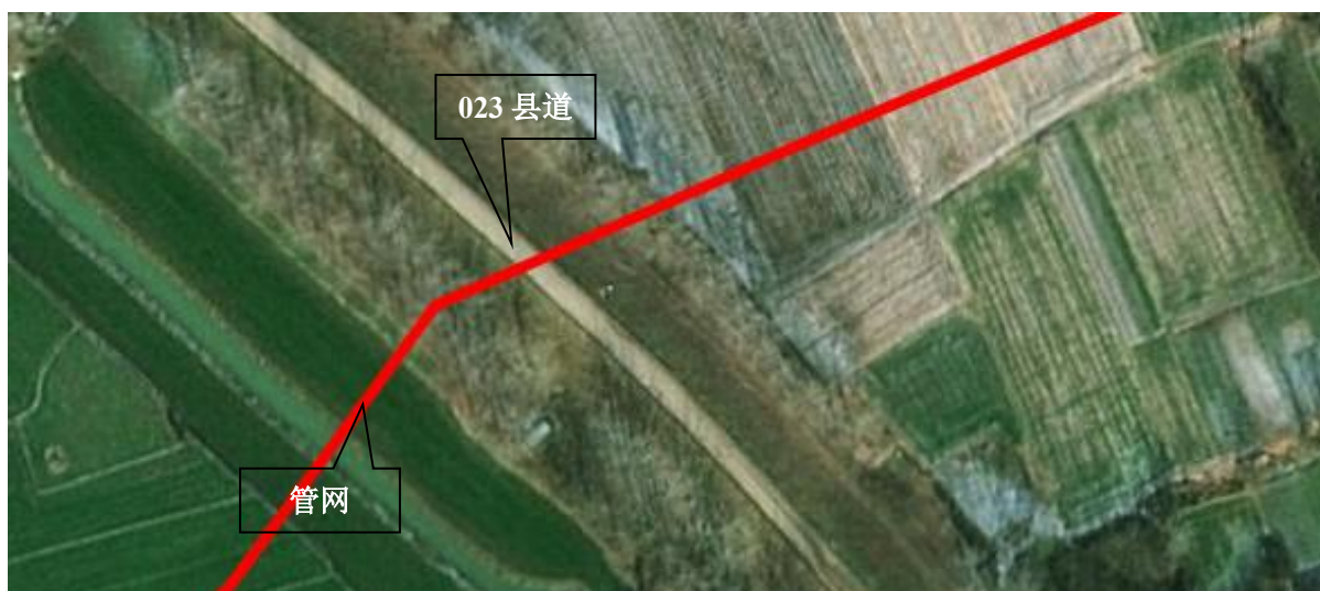
图 3.2-18 管道穿越县道
