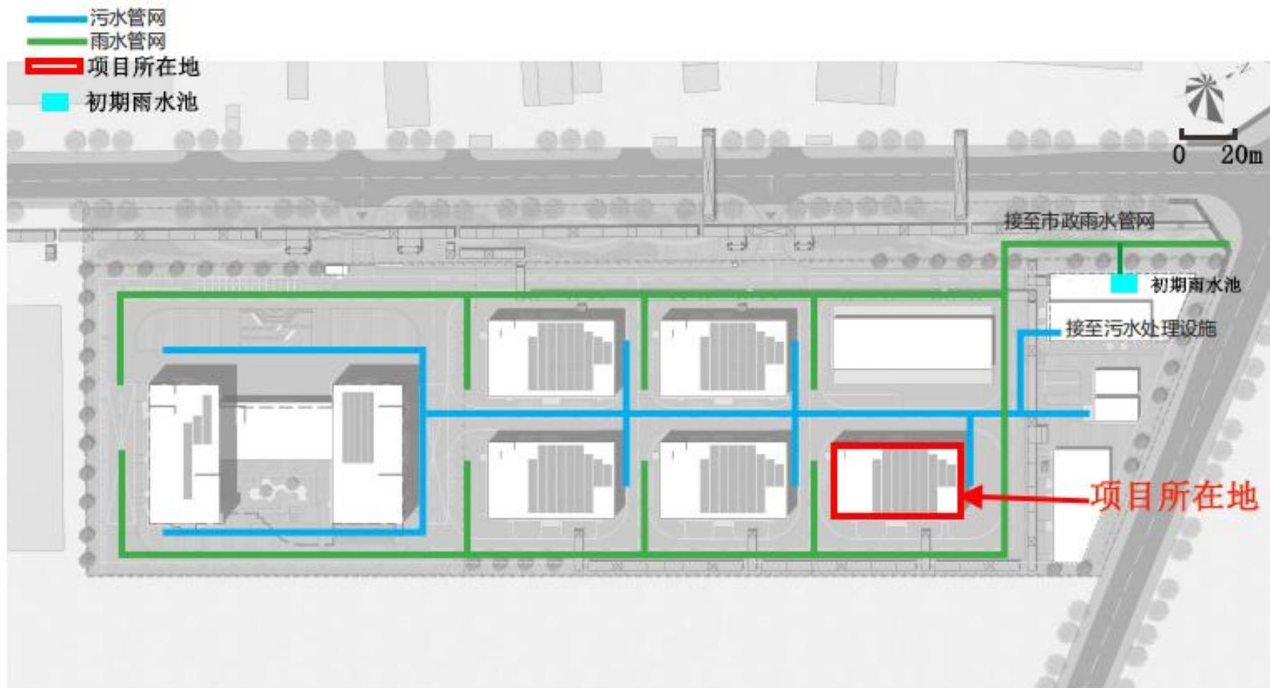
图 3.1-6 中试基地内雨污管网走向图
