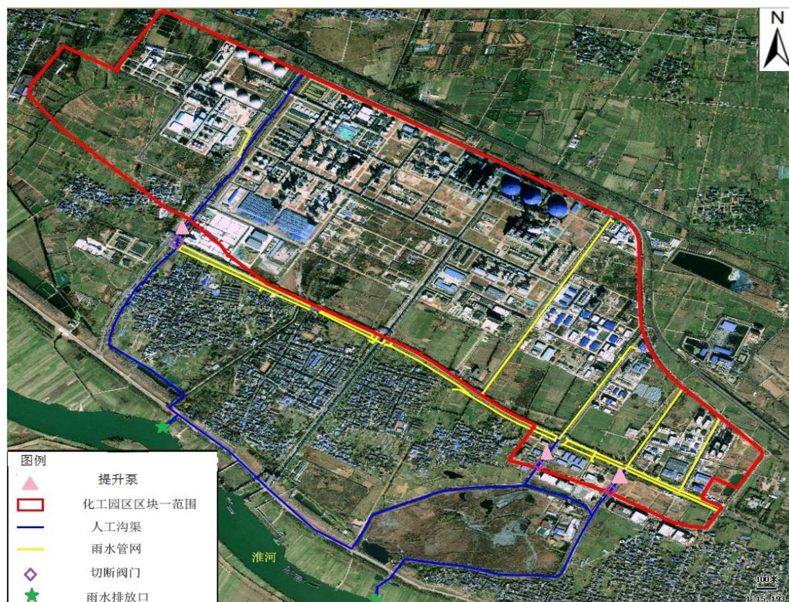
图 7.2.3-1 潘集化工园区三级防控闸门和事故水提升方案示意图
