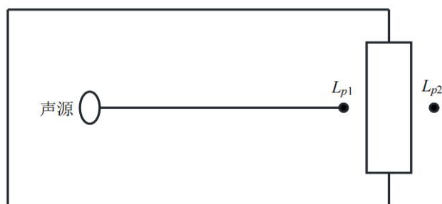
图 4-3 室内声源等效为室外声源图例
