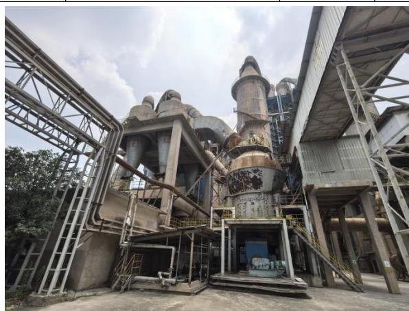
水泥窑窑尾高效布袋除尘器
