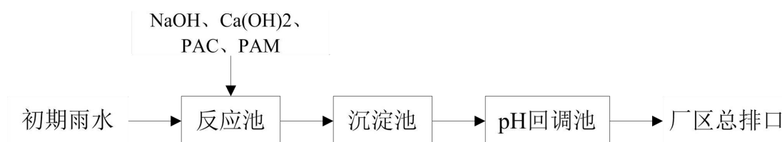
图 6.2-4 初期雨水处理工艺流程图
