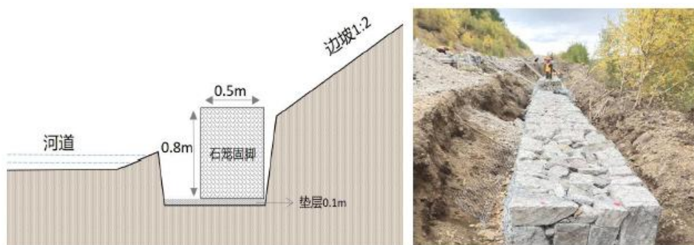
图 3.7.1-11 格宾石笼设计示意图
