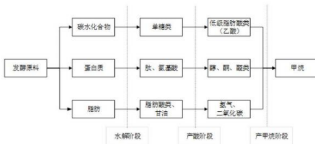
图 4.3-6 沼气发酵原理图
